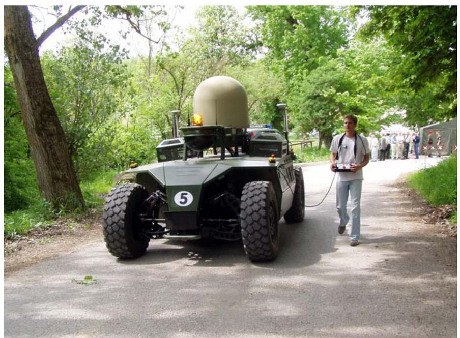
Roboter KLT: Ferngesteuerte Fahrzeuge und Fluggeräte, hier das Versuchsmodell eines aus bis zu 1000 Kilometer über Satelliten steuerbaren KLT (Kommunikations- und Lenkungsträger), werden noch an Bedeutung gewinnen
