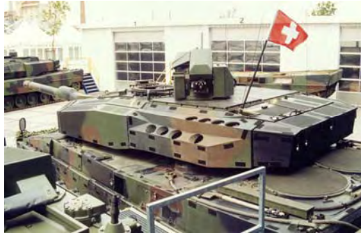
Verbesserungen des Seitenschutzes an den Turmflanken am Leopard 2 A6 Ex und am Panzer 87 der schweizer Panzertruppe
